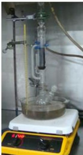
**Figura 1** Sistema usado para funcionalizar CNTs con SOCI<sub>2</sub>.
